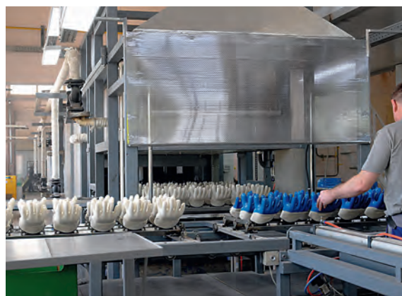
Автоматическая линия по производству перчаток с полимерным покрытием.
